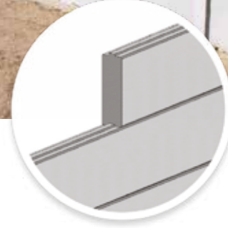
Şekil 3. Ytong panellerin lambazivana profil yapısı
